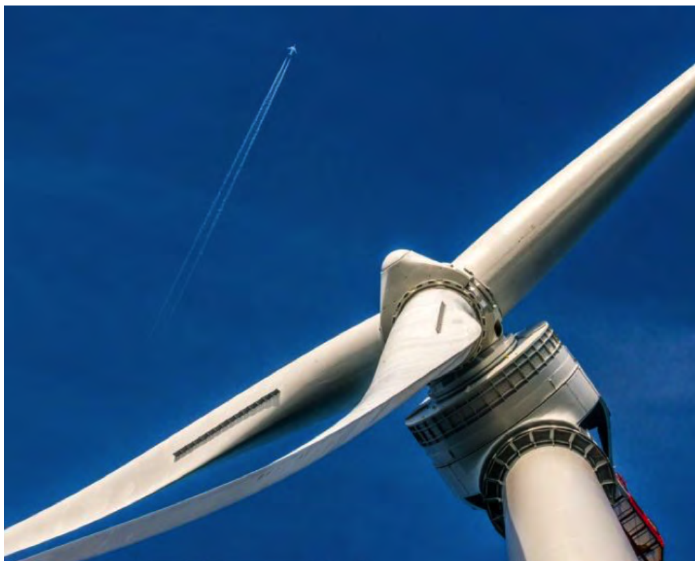
风力机的叶片翼型与飞机的机翼具有相似的设计
