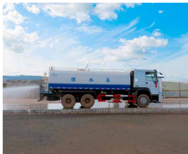
几内亚苏阿皮蒂项目道路洒水降尘
